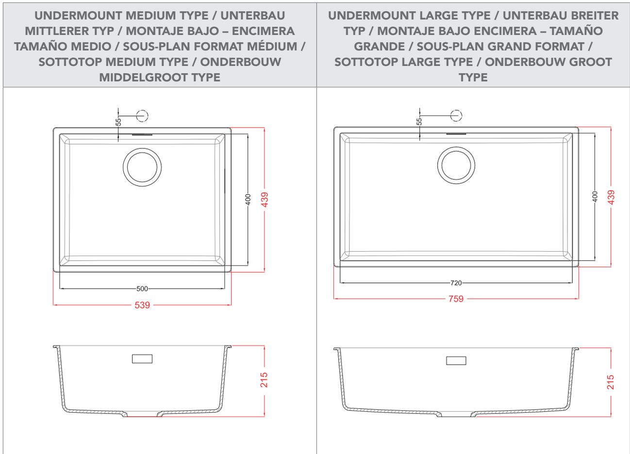
**4.5 UNDERMOUNT SETUP / UNTERBAU-EINRICHTUNG / CONFIGURACIÓN BAJO ENCIMERA /
